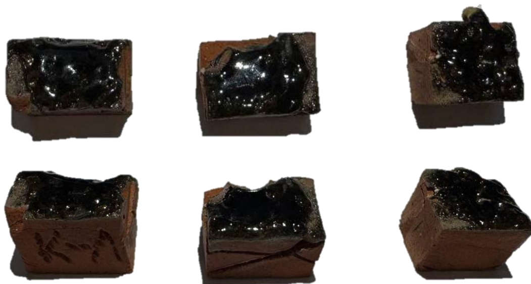
Рисунок 3 - Экспериментальные образцы. После обработки плазмой
