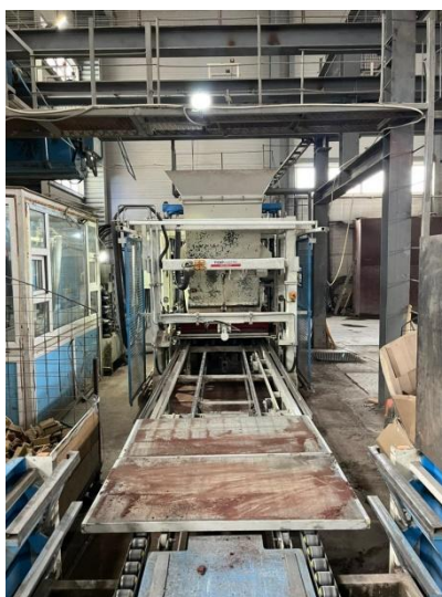
3 Сурет - Автоматты вагонетка арқылы дірілдеу машинасы
