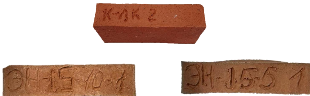
Рисунок 2 - Экспериментальные образцы. До обработки плазмой
