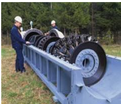
Рисунок 1 - Ультразвуковой дефектоскоп интрузивного типа
