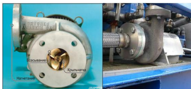
Рисунок 5 – Бустерный центробежный насос для закачки жидкого азота
