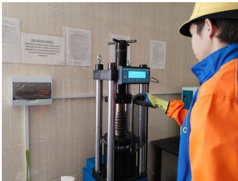
Рисунок 4 – Уплотнение смеси на гидравлическом прессе
