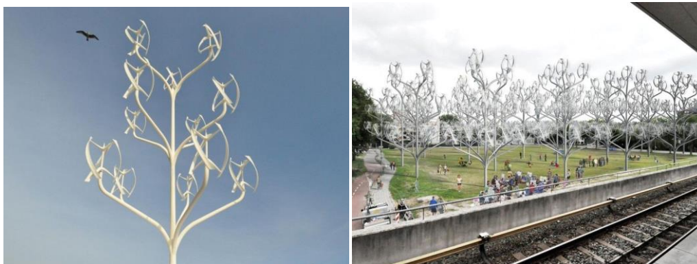
Рисунок 2 – Древообразные установки «Power Flowers» с ветряными турбинами с вертикальной осью вращения
