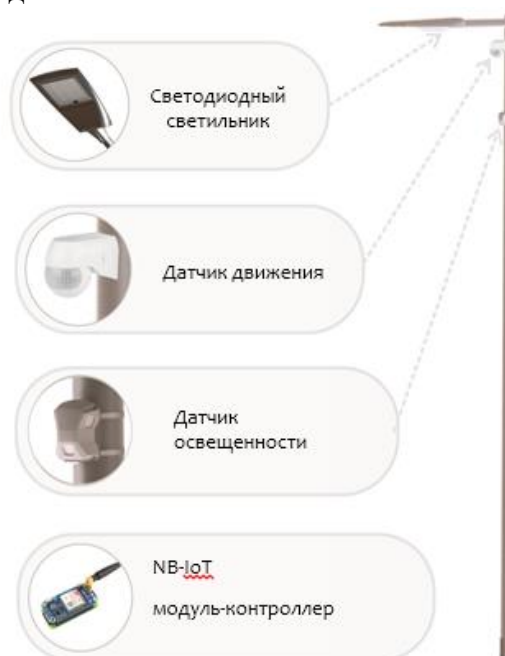
Рисунок 1. Опора автоматизированной системы освещения
