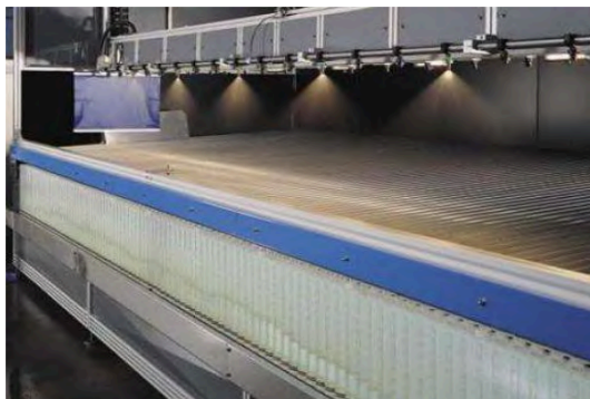
Сурет 3. Бүріккіштің бүріккіш жүйесін өндірістік сынау (Teejet Technologies, Spraying Systems Co)
