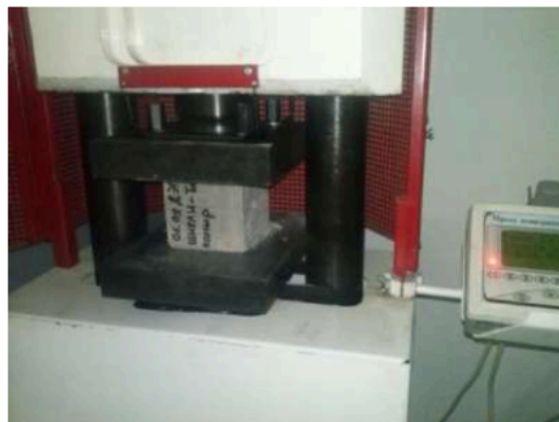
Рисунок 1 – Испытание цементобетона в растворах противогололедных реагентов: а – выдерживание образцов в соевом растворе; б – испытания образцов на прессе.
