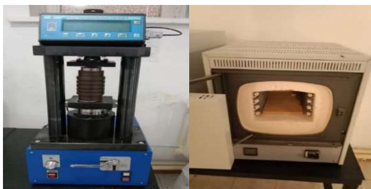
3-сурет – Күйдіруге арналған пресс және пеш
