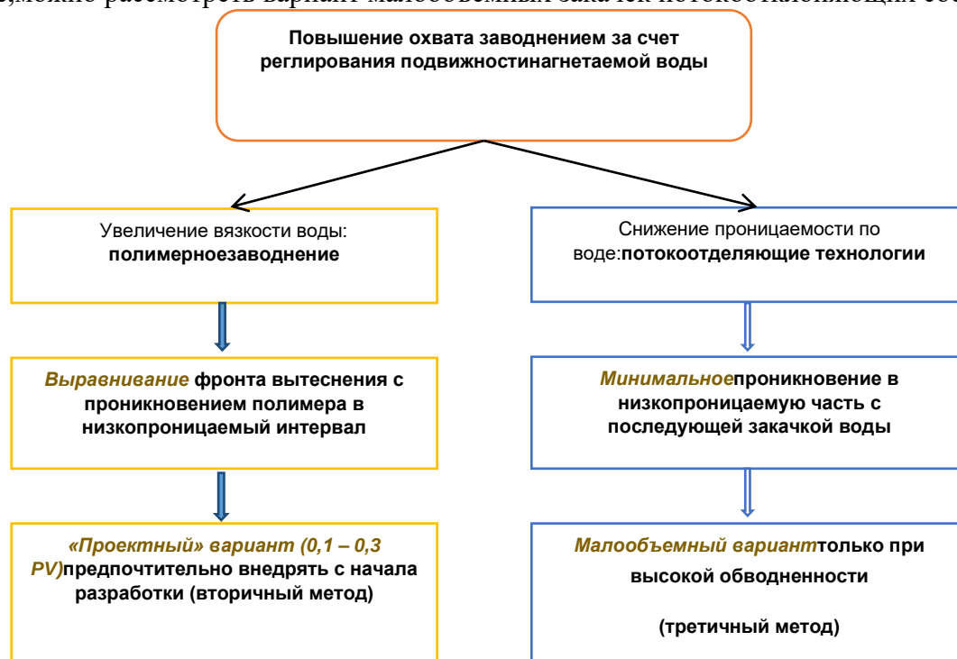
Рисунок 2. Подходы к ликвидации холостой циркуляции нагнетаемой воды
