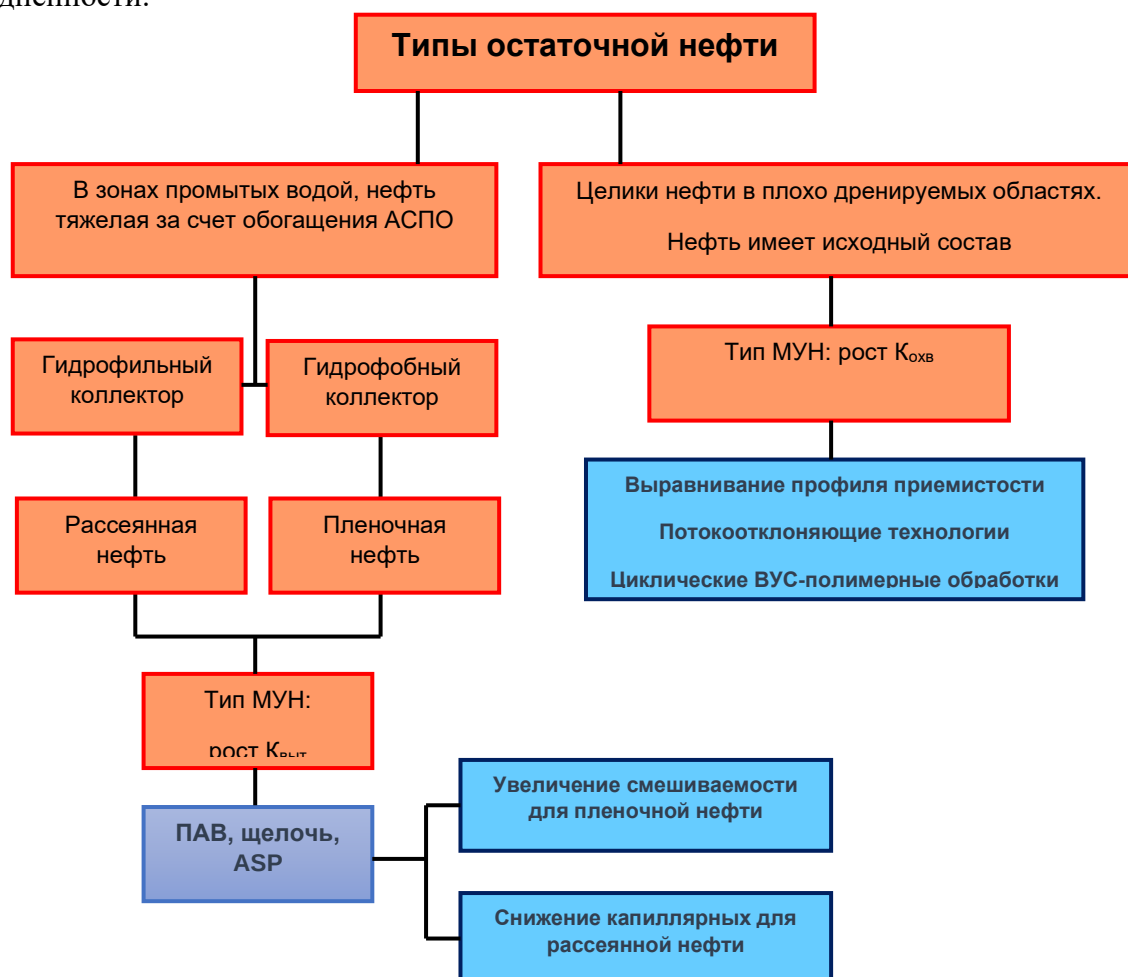
Рисунок 1. Выбор технологии МУН в зависимости от структуры остаточных запасов нефти
