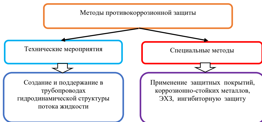
Рисунок 1 – Методы противокоррозионной защиты промысловых трубопроводов
