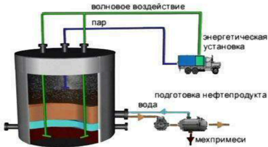
Рисунок 1- Технологическая схема мойки струей нефти с промежуточной емкостью и закачкой смывок в резервуар
