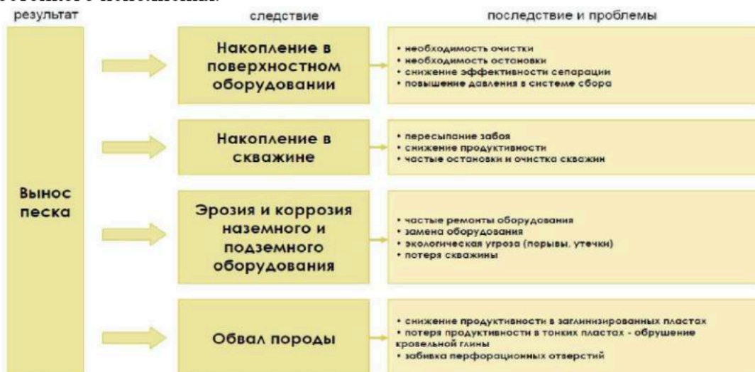
Рисунок 1. Последствия выноса механических примесей
