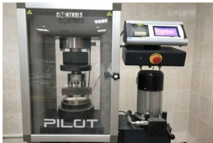
Рисунок 4 – Испытаний образцов газобетона на прочность при сжатии
