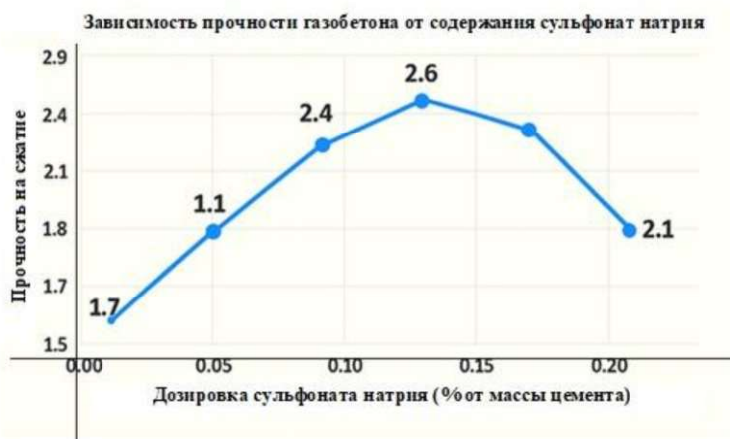
Рисунок 1 – График зависимости прочности газобетона от содержания сульфоната натрия
