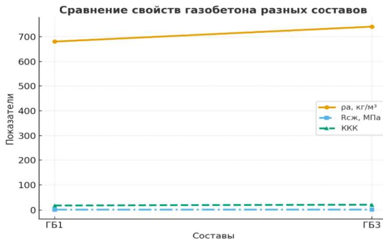
Рисунок 3 – Данные физико-механических испытаний образцов газобетона
