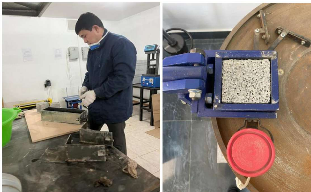
Рисунок 6 – Испытания образцов газобетона на величину истираемости
