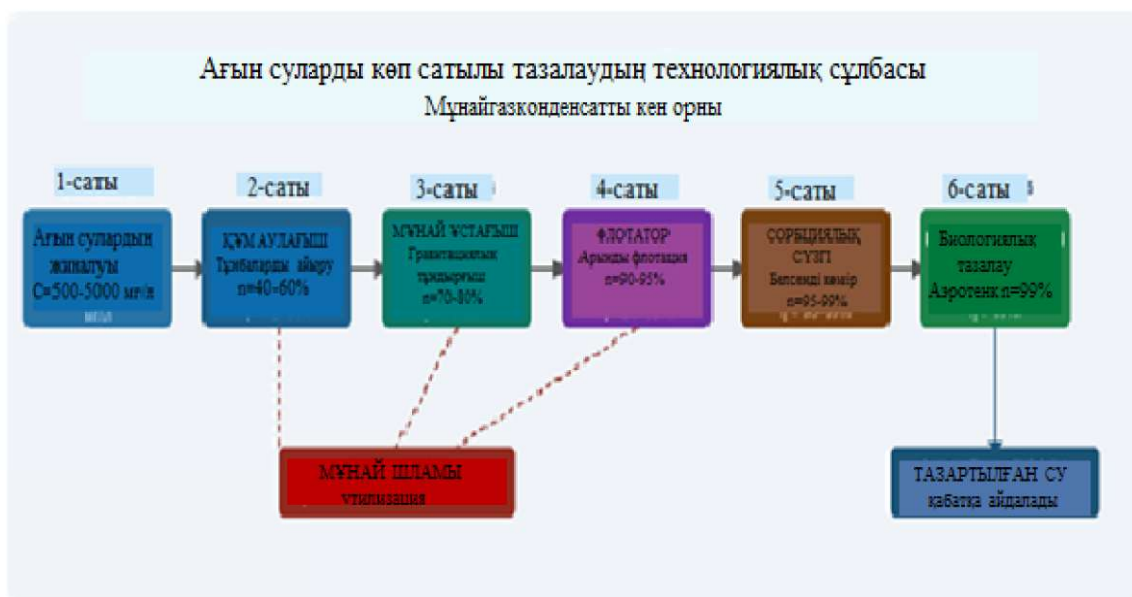
2 сурет - Мұнай-газ конденсаты кен орнының ағынды суларын көп сатылы тазартудың принциптік технологиялық сұлбасы
