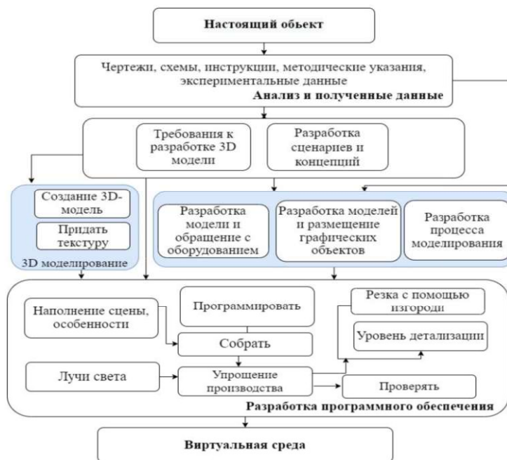
Рисунок 1 – Структура технологии разработки 3D-моделей объектов для виртуальных сред (этапы: концептуальное моделирование → полигональное/сплайн-моделирование → текстурирование → оптимизация → экспорт в BMF)
