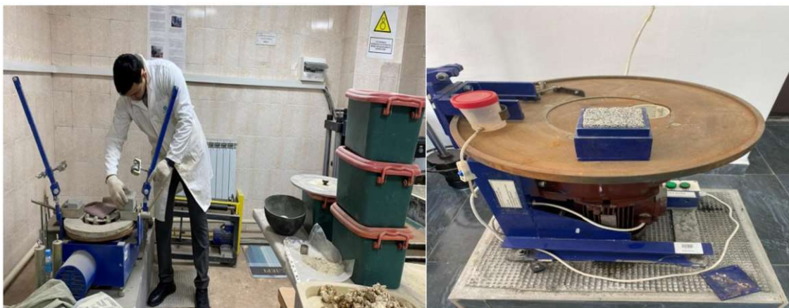
Рисунок 6 – Испытания образцов газобетона на величину истираемости
