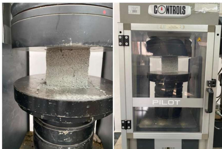
Рисунок 4 – Испытаний образцов газобетона на прочность при сжатии
