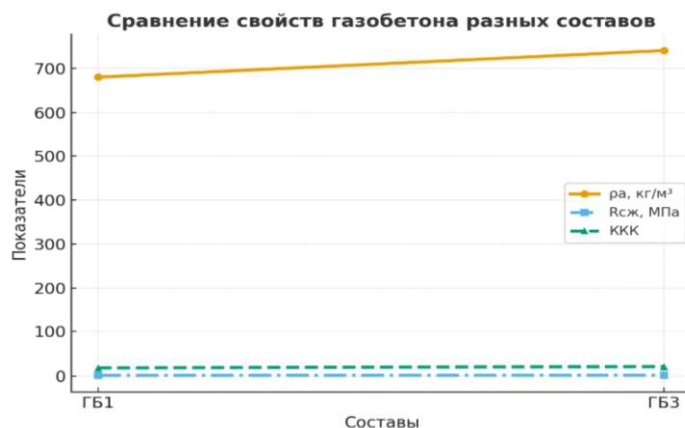
Рисунок 3 – Данные физико-механических испытаний образцов газобетона
