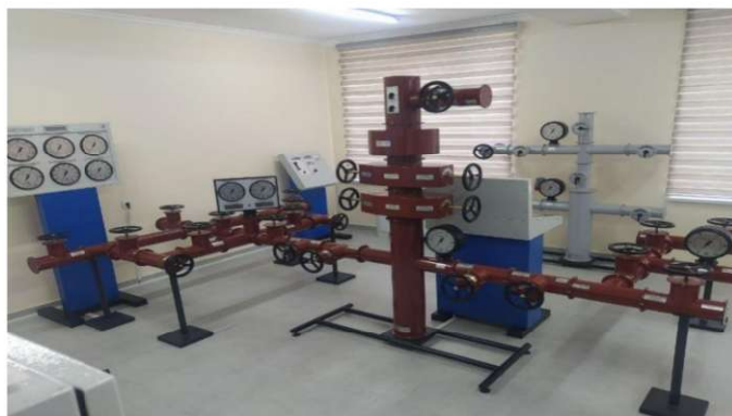
Рисунок 1 – Общий вид тренажер-имитатора АМТ-411 капитального ремонта скважин.
