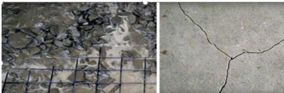
Рисунок 2 – Практическое исследование образца бетона при увеличении воды в бетонной смеси
