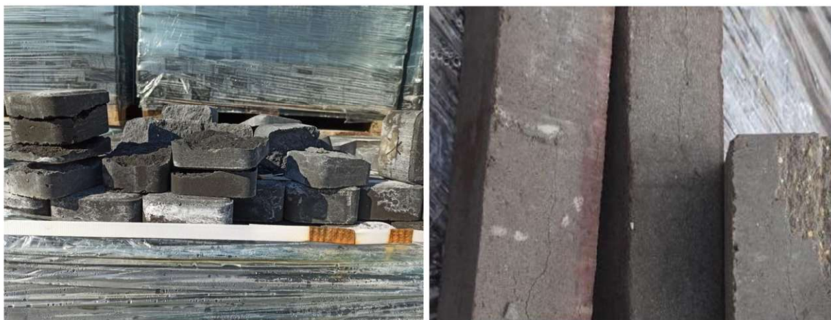
7 Сурет - Дұрыс емес ылғалдылыққа байланысты ақау.
