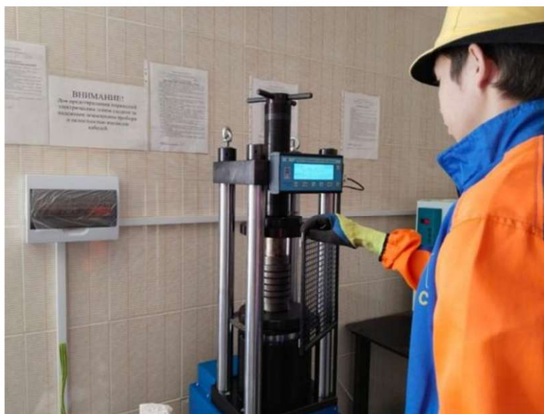
Рисунок 4 – Уплотнение смеси на гидравлическом прессе
