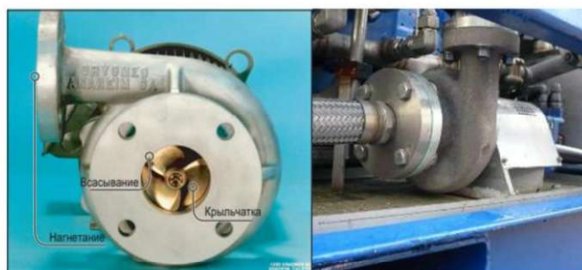
Рисунок 5 – Бустерный центробежный насос для закачки жидкого азота
